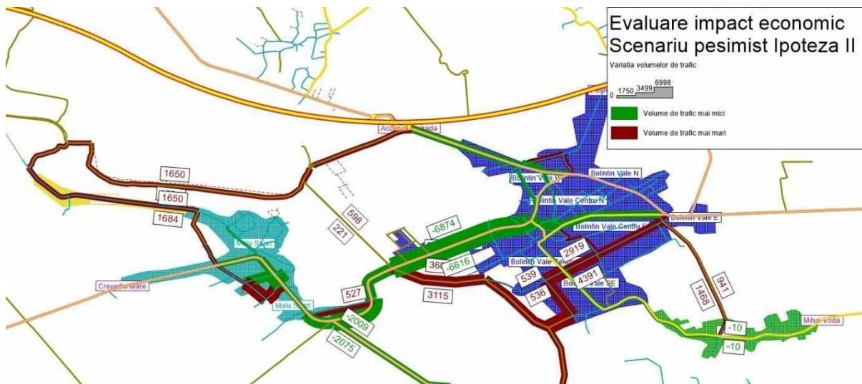
Fig. 7.1.6 Variația fluxului de vehicule în cazul implementării proiectelor din Ipoteza II pentru scenariul pesimist
