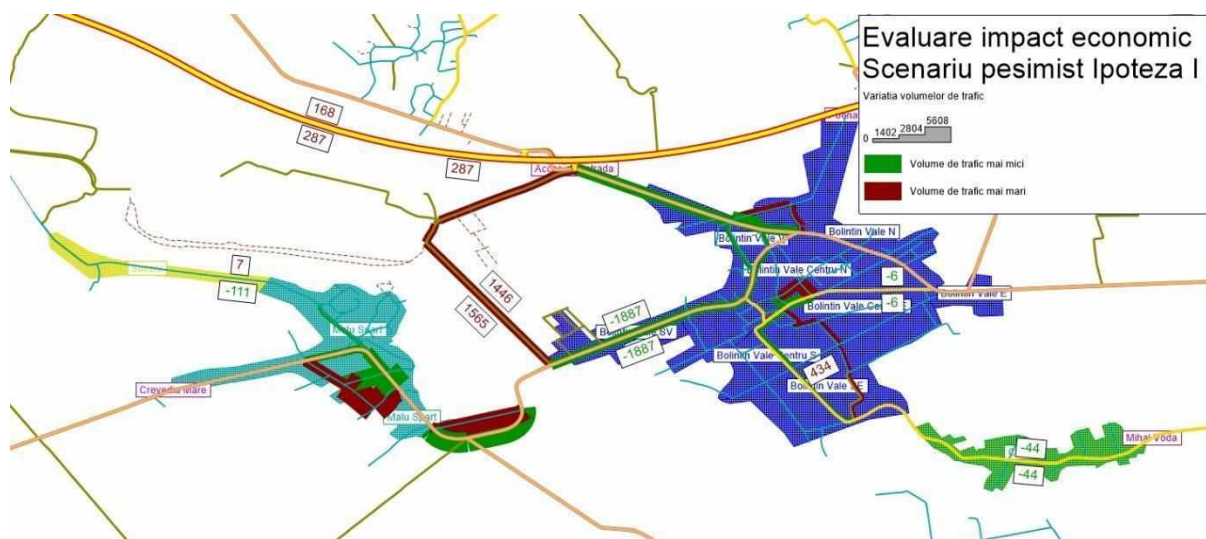
Fig. 7.1.5 Variația fluxului de vehicule în cazul implementării proiectelor din Ipoteza I pentru scenariul pesimist
